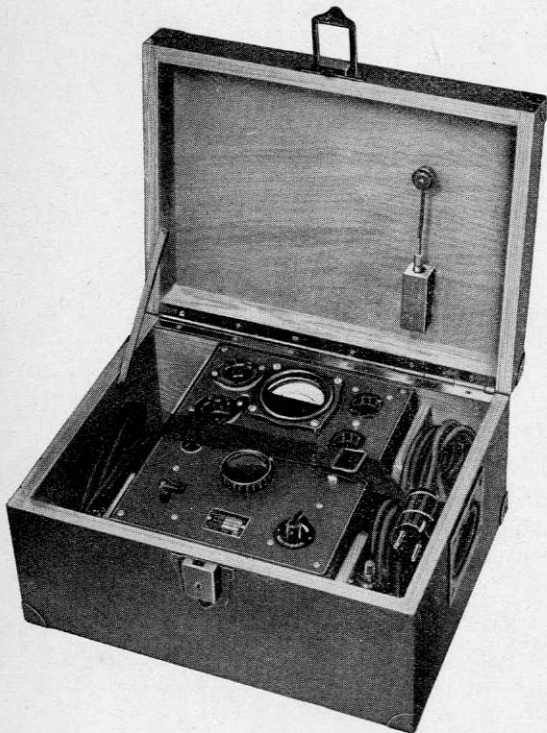
Abb. 5. Röhren-Prüf- und Meß-Gerät RPMG 2 im Transportkasten (Einschl. Zubehör)
